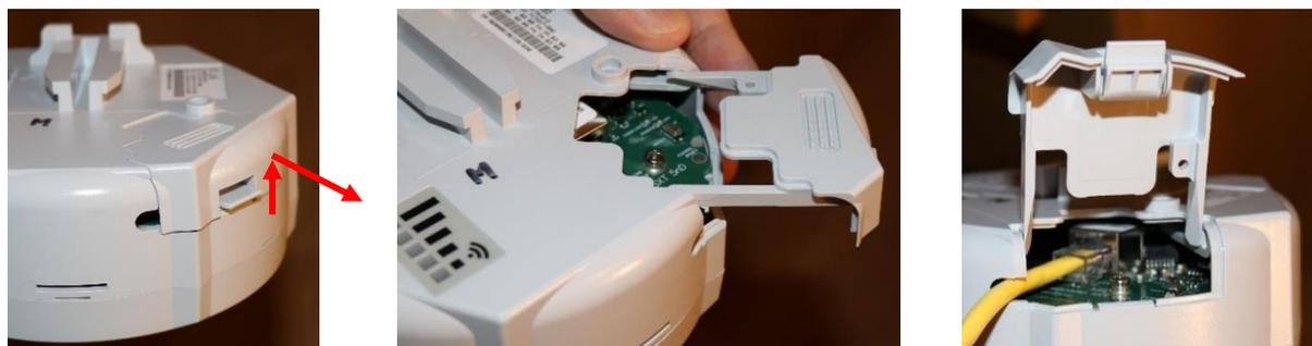
In caso sia disponibile POE, cioè corrente via cavo di rete (power over ethernet), collegare direttamente il cavo allo switch.
