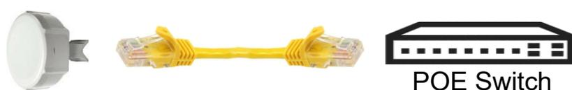
Altrimenti, collegare il cavo all'*adattatore di rete dati e alimentazione* presente nella scatola, collegare il cavo di rete dell'adattatore allo switch come pure l'adattatore di corrente alla rete da 220V utilizzando l'apposito trasformatore.
